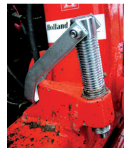
De draadspindel voor het overbuik/overrug afstellen. Een halve slag verstellen gaat niet (foto onder). De spindel is niet geblokkeerd.
