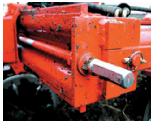
Met behulp van sleutel 24 verstel je de breedte-instelling van de ploeg.
