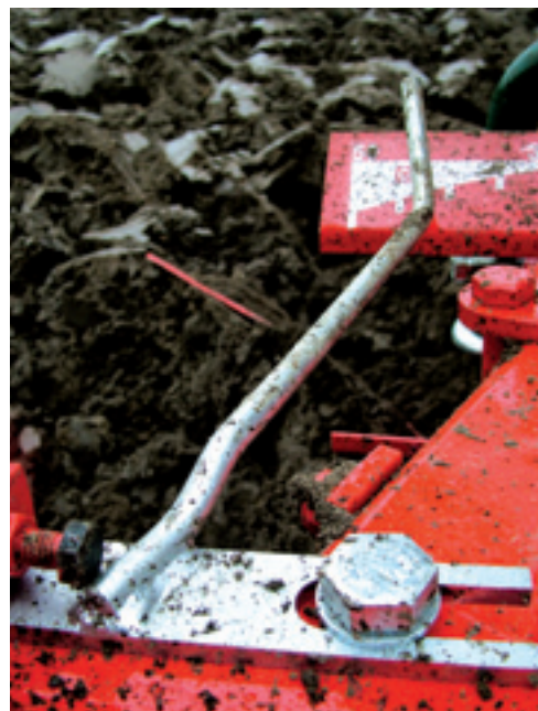
Om de wijzer af te stellen kun je deze naar links of rechts verschuiven. Hier zit de aanwijzer tegen de bout.
