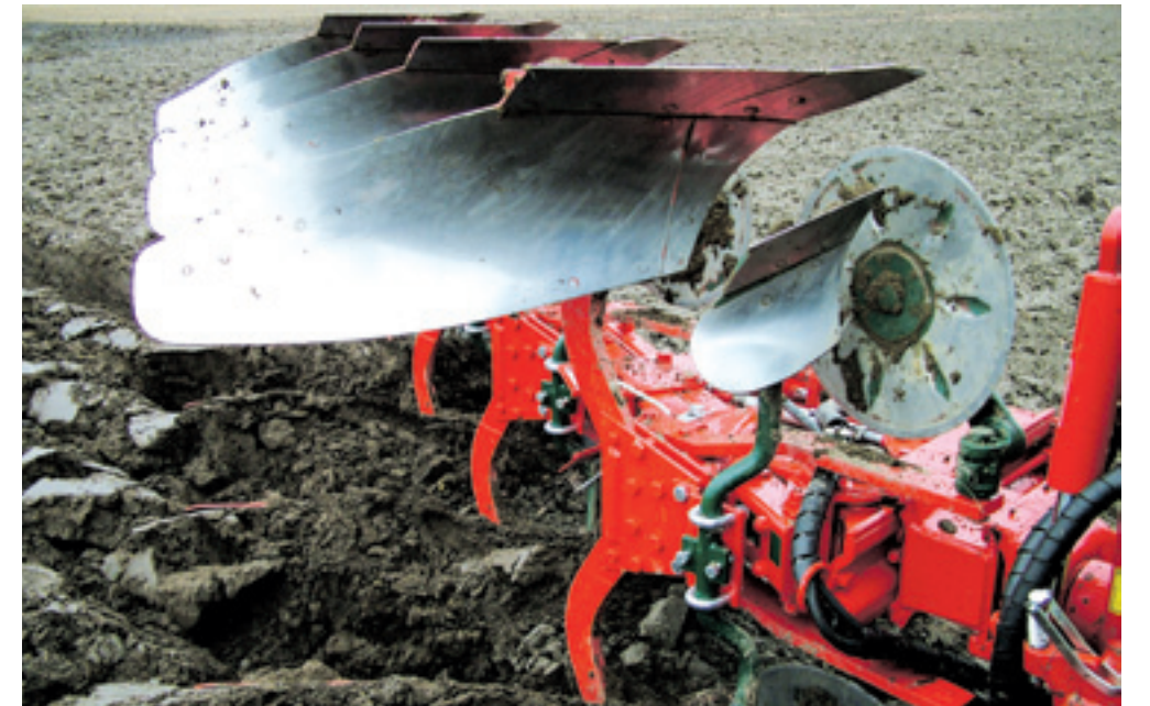
De grond komt soepel op het, uit vier delen bestaande, rister. Het houdt de grond even vast en keert het daarna voldoende.
