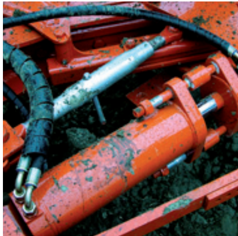
De treklijn instellen doe je met behulp van de draaispindel, het instellen van de snijbreedte gebeurt met de memorycilinder.
